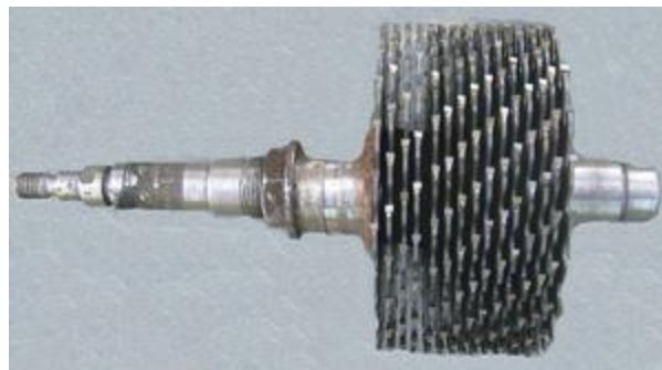
Рис.5. Подрібнювач з дискових пилок
