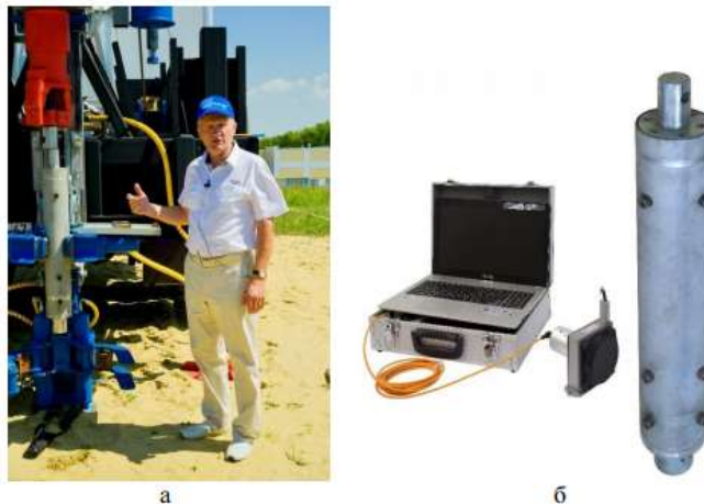
Рис. 1. Випробування ґрунтів методом бурового зондування:
